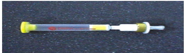
오존 측정을 위한 DNPH 카트리지 (Supelco, U.S.A)
